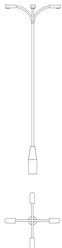
POSTE CONCRETO SEÇÃO CIRCULAR COMPRIMENTO=9M 4 PÉTALAS
