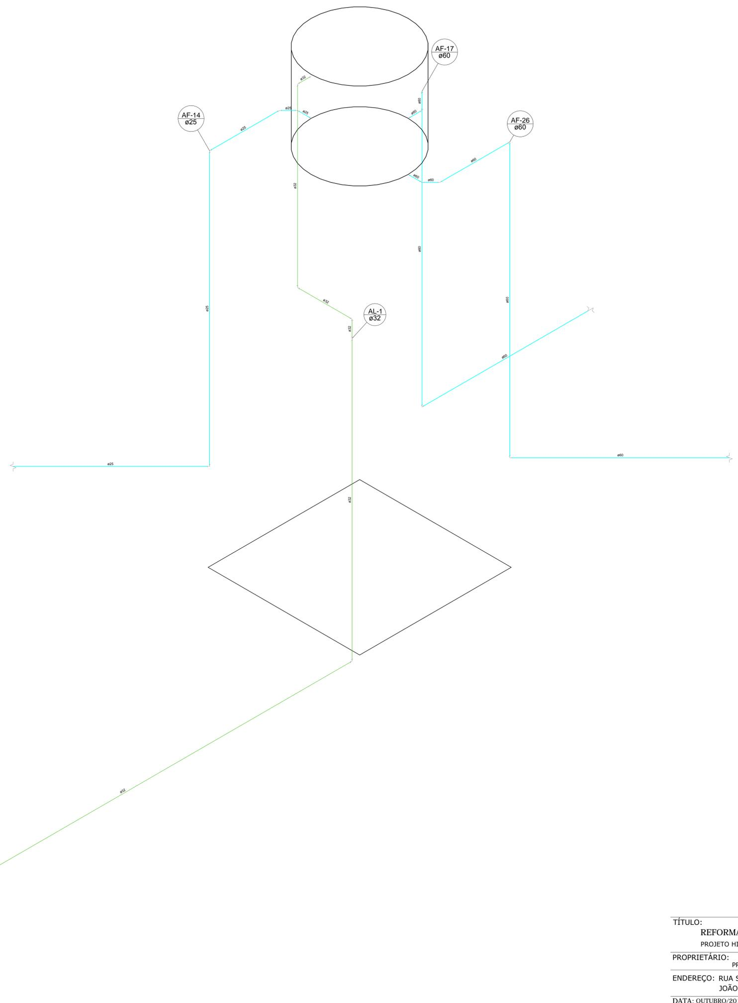
Detalhe Isométrico - H5
