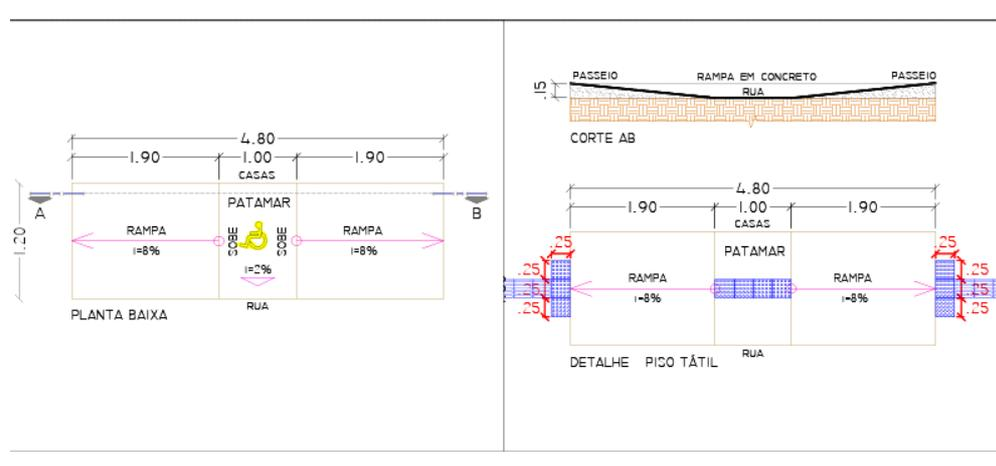
**Planta Baixa detalhamento Rampa de acessibilidade NBR 9050**
